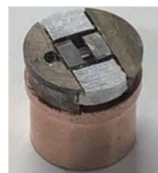
図 1 Thermal contraction strain cell (OD 9.5 mm).
