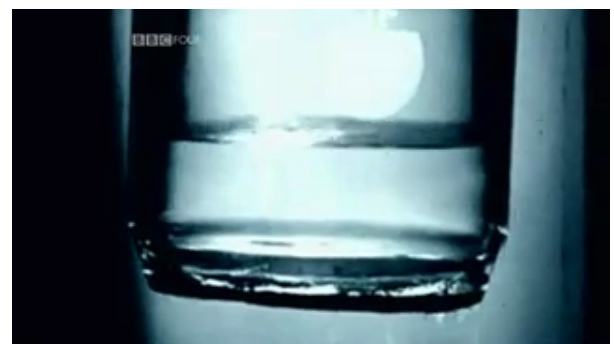
T < 2.17\text{K} で液面から蒸発する液体ヘリウム
