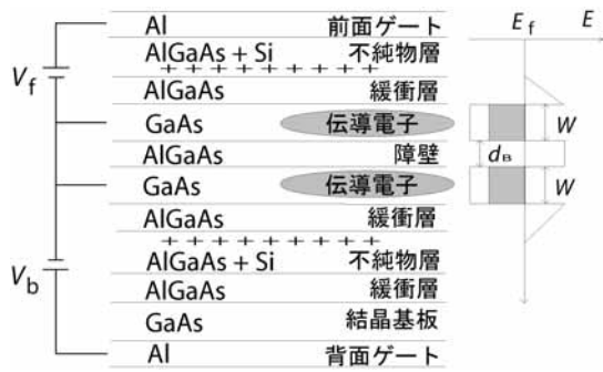
図4 試料構造図 .GaAs 基板に GaAs と AlGaAs を積層し, GaAs 層に伝導電子層を作る . 前面および背面ゲートの電圧 V_f , V_b をかけることにより, 電子密度を独立に変化させることができる . W は井戸, d_B は障壁層の幅を示す .
