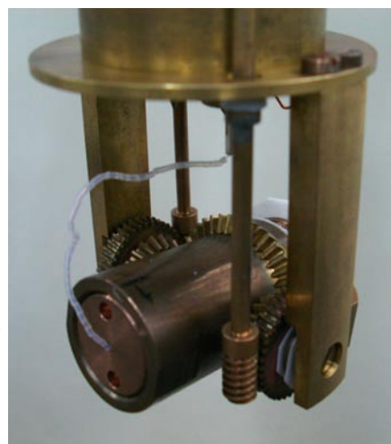
図1 角度回転機構付き NMR プローブの先端部分。デファレンシャルギアを改良し、試料を磁場に対して任意の角度に向けることが出来る。写真のように圧力セルをマウントすることも出来る。
