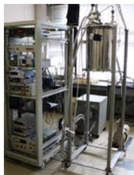
図 開発中の無冷媒冷凍機（左図）と、冷却過程におけるRuO 2 抵抗温度計の抵抗値の時間変化（右図）
