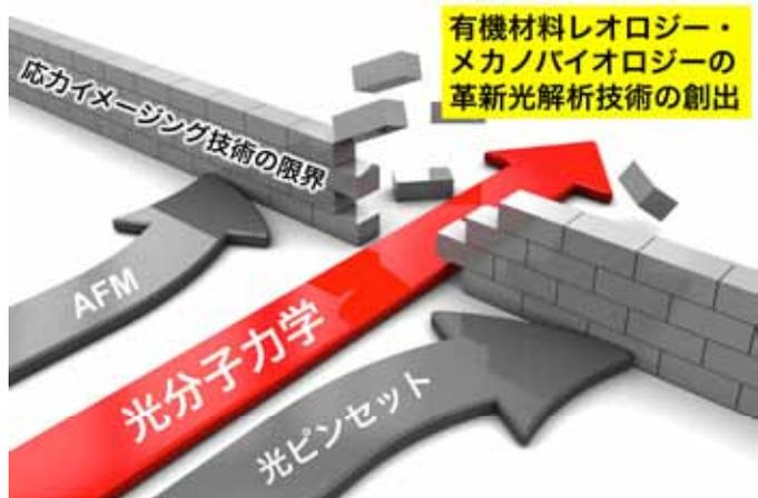
開発した発光分子 FLAP は、1 つ 1 つの分子が外部からかかる微弱な張力を感じると可逆に分子形状と発光波長を変え、理論的には分子分解能の応力イメージングを可能とする。しかも、表面解析しかできない AFM や広範囲イメージングを苦手とする光ピンセットとは異なり、対象物の内部で応力分布を可視化できる。精密有機合成によって FLAP の応答する応力域、励起・発光波長、対象物内部における局在箇所を自在に設計することで、環境を選ばずにナノレベルの応力分布をリアルタイムに広範囲で可視化する革新的な光解析技術の創出を目指す。
