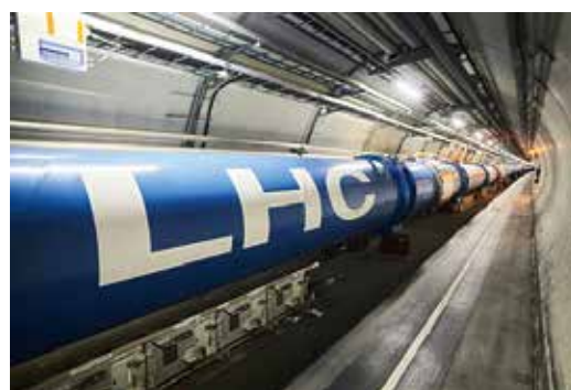
図 1. Large Hadron Collider (LHC) の低温超伝導電磁石 [1].
