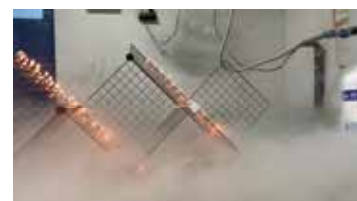
図 1 充填中の滞留窒素ガスによる蝋燭の窒息消火
